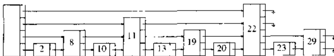
图 10-59 带有指向前面第 2^i 个表元素的指针的链表
